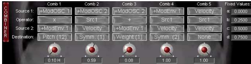
Abbildung 2.10.: Elemente der Modulations-Combiner.
