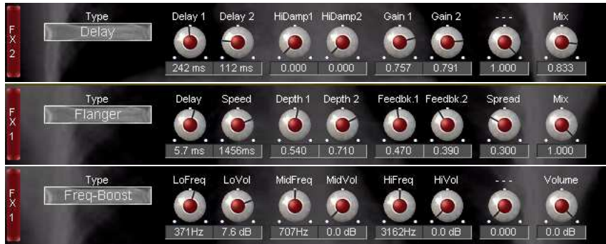
Abbildung 2.14.: Verschiedene Effekte und ihre Parameter. Oben: Parameter für die Effekte One Shot Delay, Delay, X-Delay, Spread Delay, Diff. Delay, Pan.Diff. Delay, Multi-Delay. Mitte: Parameter für die Effekte Chorus, Flanger, Phaser. Unten: Parameter für den Effekt Freq-Boost.
